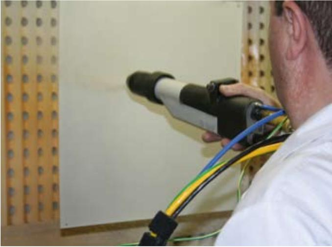
8 - Applicazione della polvere UV sullo strato di poliestere polimerizzato.
