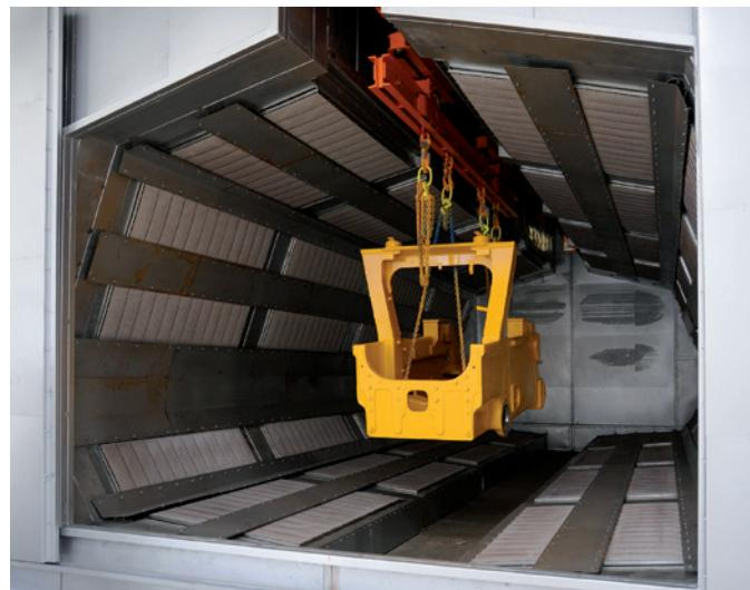
solo una vuelta de la cadena, procesos de recubrimiento en polvo bicapa; para evaluar la reducción de las emisiones de los procesos líquidos de disolvente.
