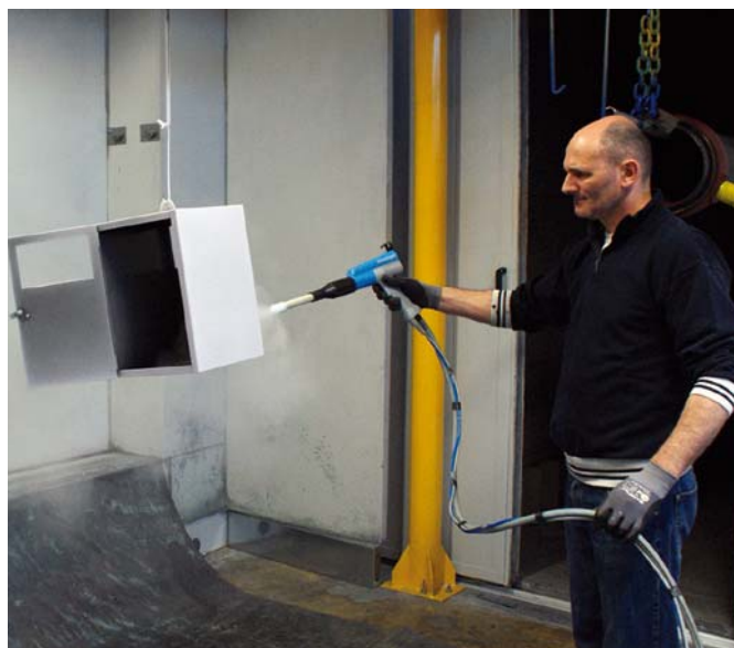
15 - Una fase di applicazione della mano finale trasparente con polimerizzazione UV avvenuta presso Euroimpianti a Valeggio sul Mincio (VR). Une phase d'application de la couche finale transparente avec polymérisation UV réalisée par Euroimpianti à Valeggio sul Mincio (VR).
