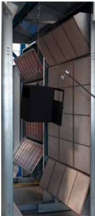
14 - Forno a pannelli catalitici IR per cottura vernici in polvere.
