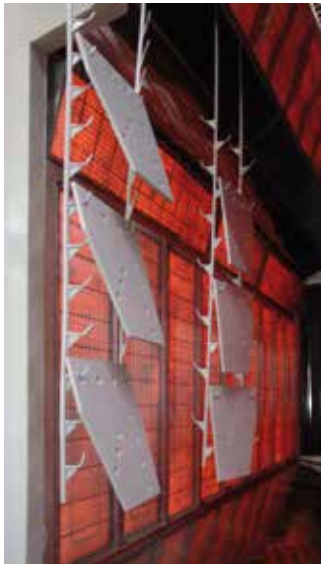
13 - Forno a pannelli catalitici IR Infragas per cottura vernici liquide.
